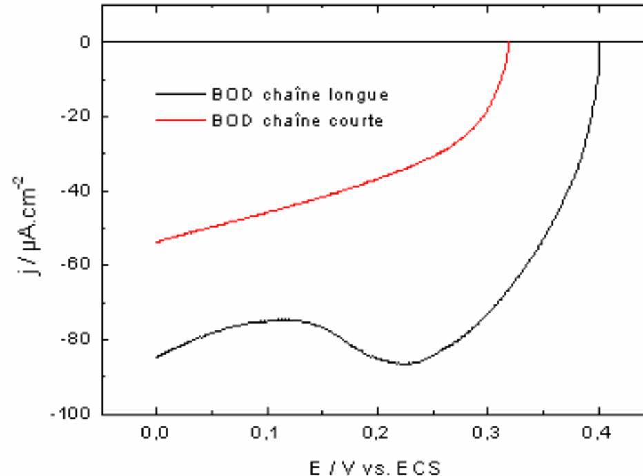
L'activité de la BOD greffée sur une chaîne longue semble très supérieure à celle de la BOD greffée sur chaîne courte. Vous noterez que l'écart entre les potentiels d'équilibre des deux électrodes est très important.
