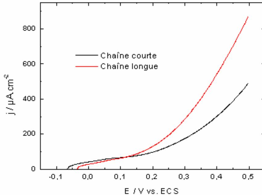
Ces deux courbes montrent qu'aucune différence d'activité électrochimique significative n'est observée entre la configuration chaîne courte et la configuration chaîne longue
